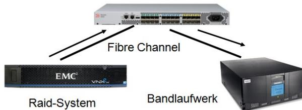
Moderne Backup-Software für virtuelle Umgebungen nutzt meist dieses Prinzip. Ein spezieller Backupserver nimmt sich die LUN mit der zu sichernden virtuellen Maschine (oder einen SnapShot dieser LUN) und sichert auf ein Festplattensystem oder ein Tape.
