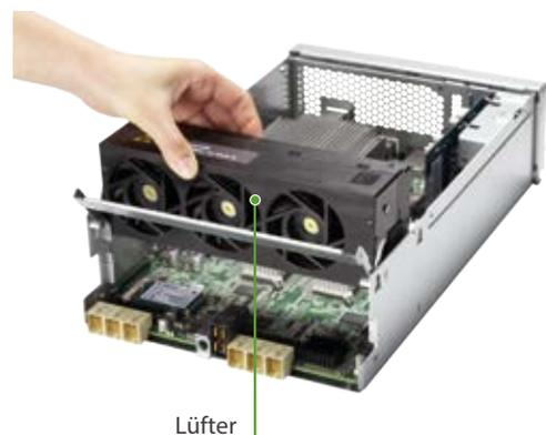
Die Lüftermodule können ebenfalls einfach ausgetauscht werden.
