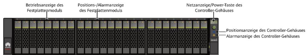
**Abbildung 3-113** Anzeigen am Frontpanel eines 2-HE-Controller-Gehäuses für 36 Festplatten
