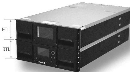
Jedes Modul verfügt über zwei herausnehmbare Magazine mit je 20 Slots für LTO-Medien, wobei per Modul fünf Slots als Mail-Slots für den selektiven Zugriff genutzt werden können.
